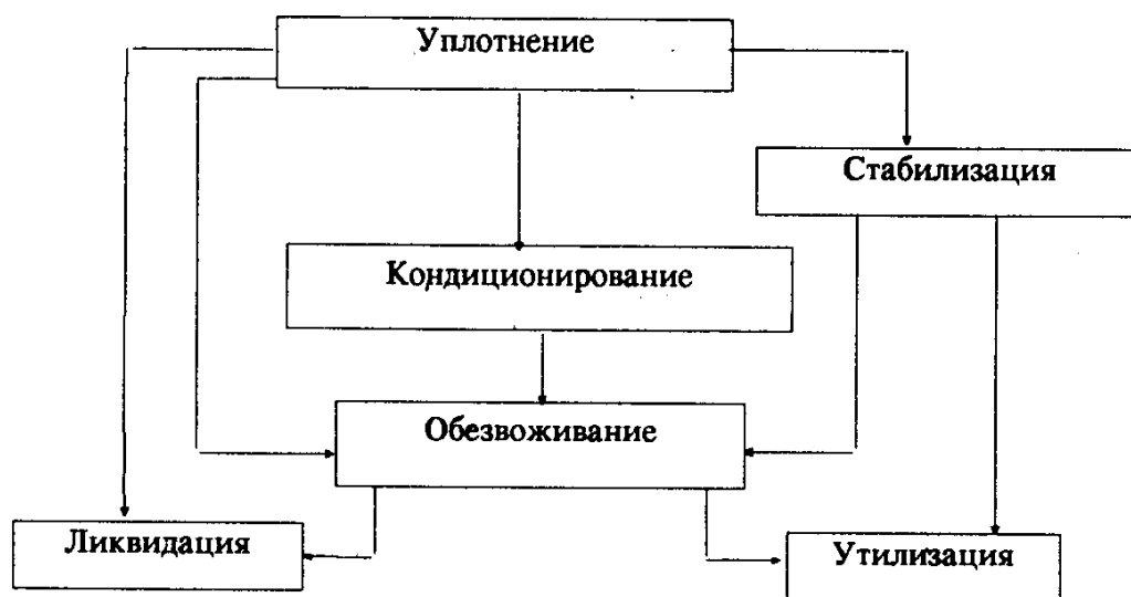
Рис. 11. Схема типовых процессов, применяемых для обработки осадков производственных стоков /74/
